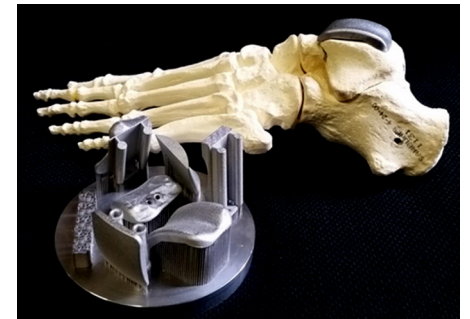
Impianti prototipali di protesi di caviglia su-misura ottenuti con sinterizzazione di polveri di cromo-cobalto.
