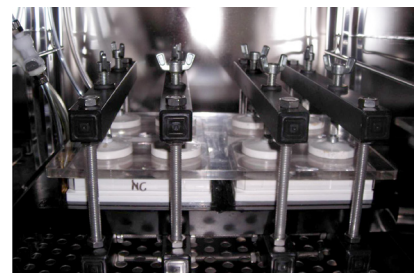
Figure 2. Bioreattore utilizzato per allestire colture cellulari o tissutali in diverse condizioni sperimentali: regolazione della tensione di ossigeno e imposizione di stimolazioni meccaniche controllate.
