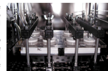
Figura 1. Bioreattore utilizzato per allestire colture cellulari o tissutali in diverse condizioni sperimentali: regolazione della tensione di ossigeno e imposizione di stimolazioni meccaniche controllate
