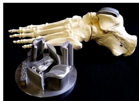
Impianti prototipali di protesi di caviglia su-misura ottenuti con sinterizzazione di polveri di cromo-cobalto.
