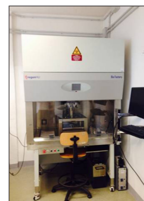
Figura 3. Piattaforma 3D che consente di stampare biomateriali con cellule e/o biomolecole e allo scopo di costruire strutture composite tridimensionali che mimano l'architettura del tessuto muscoloscheletrico.
