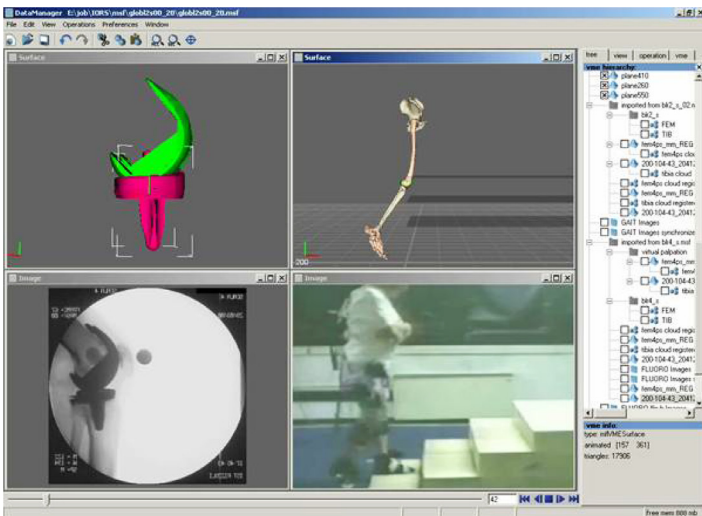
Combinazione grafica, durante la salita delle scale, di analisi del movimento complessiva (destra) e corrispondente analisi cinematica tramite videofluoroscopia (sinistra) della articolazione del ginocchio protesizzata.
